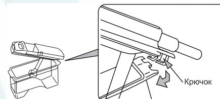
**Ежемесячное обслуживание****Трубка подачи воды и насос****Как снять и установить****1 Поверните трубку в указанном стрелкой направлении и снимите ее с крышки.**
